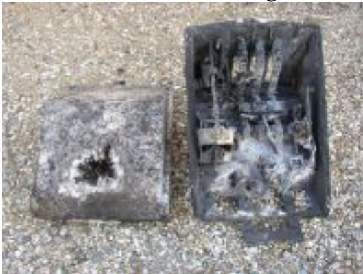
Au cimetière, un disjoncteur en bien mauvais état
